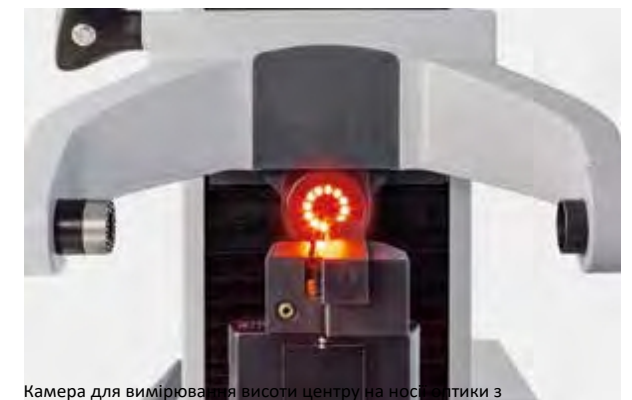
Камера для вимірювання висоти центру на настільній платі з кільцевим світлодіодним освітленням
