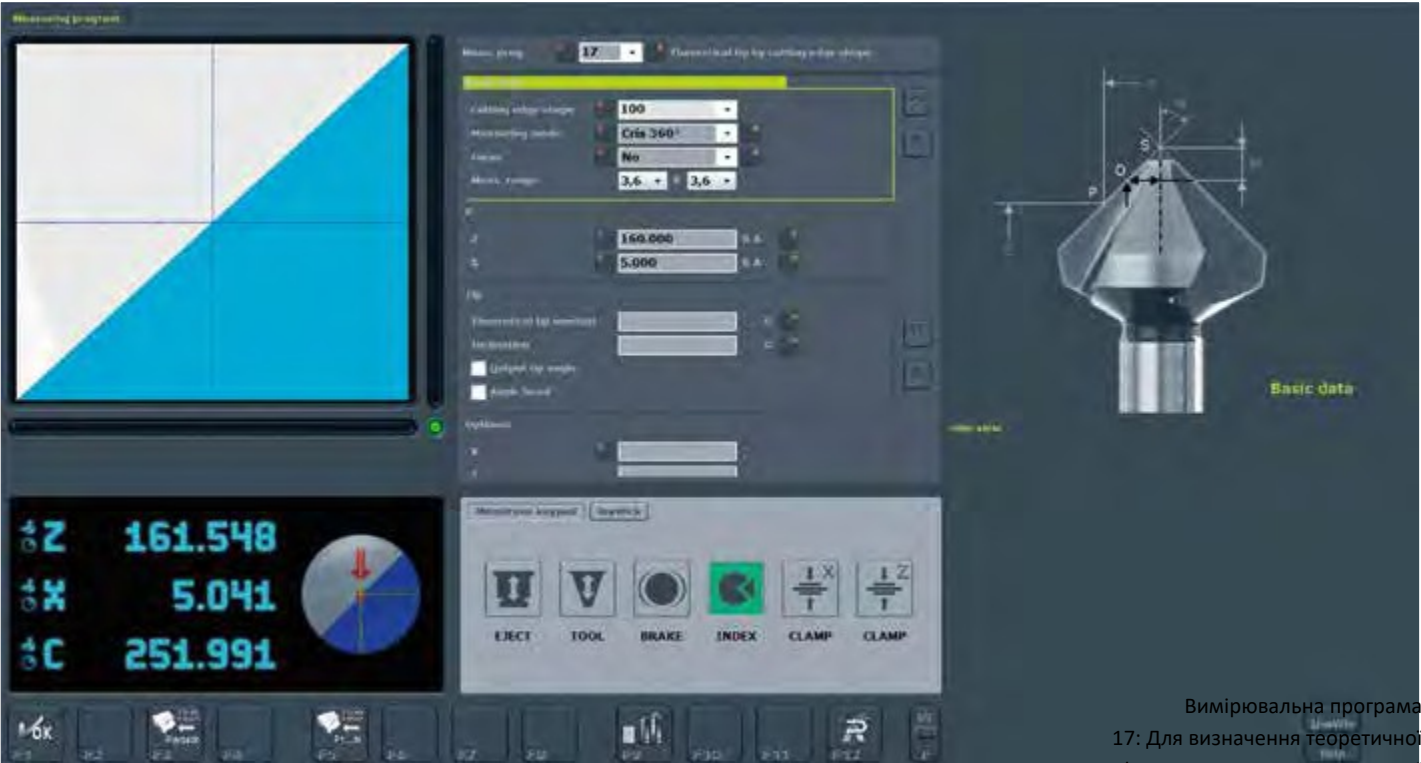
Програма вимірювання 1: Для вимірювання однолезових розверток з опорною смужкою у затискахі принципу калібрування.
