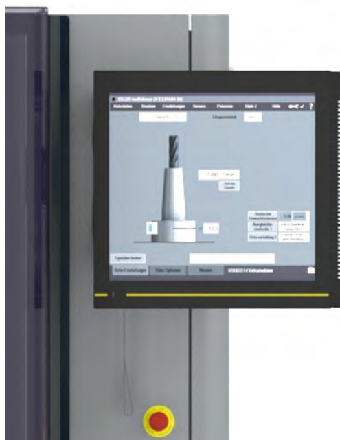
Управління вимірювальною машиною за допомогою програмного забезпечення ZOLLER на «toolBalancer» з кронштейном для монітора
