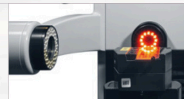
Камера вимірювання висоти центра на носії оптики з LED-кільцевим світлом
