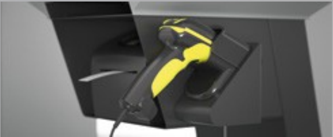
Ідентифікація інструменту за допомогою сканера на блоці управління «cockpit»
