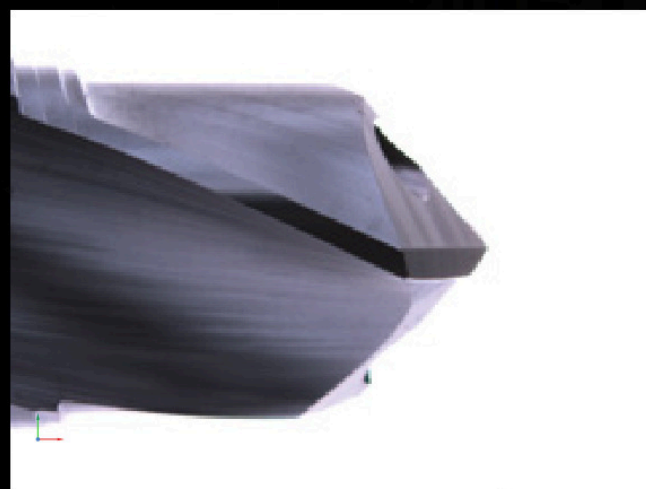
Фронтальний вигляд ступінчастого свердла у »romLightTube« Вид по периферії ступінчастого свердла у »romLightTube«
