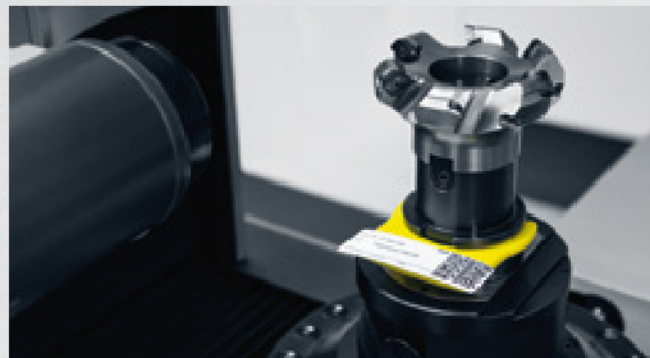
QR-етикетка з фактичними даними інструменту Технологія »z.DMI« для двонаправленої передачі даних
